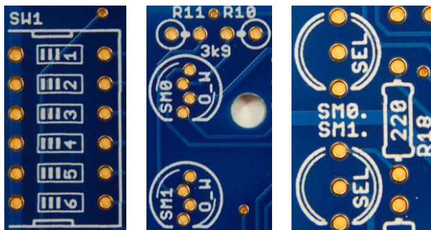
Abbildung 5: PCB des DIP-Schalters und der RGB-LED in Vergrößerung
